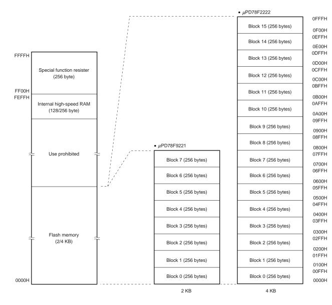
Figure 18-1. Flash Memory Mapping
